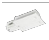
Alimentador, tierra a la izquierda 16A máx. | Policarbonato (PC) / acero L: 12,2 cm A: 6 cm H: 3,4 cm
